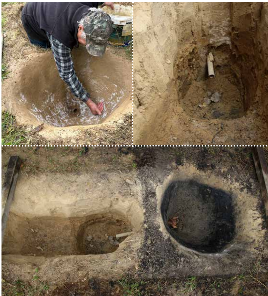
Wylepianie jamy gliną. Komora odbioru dziegciu z widoczną rurką. Oczyszczona jama po zakończonym wypale, widok z góry.
