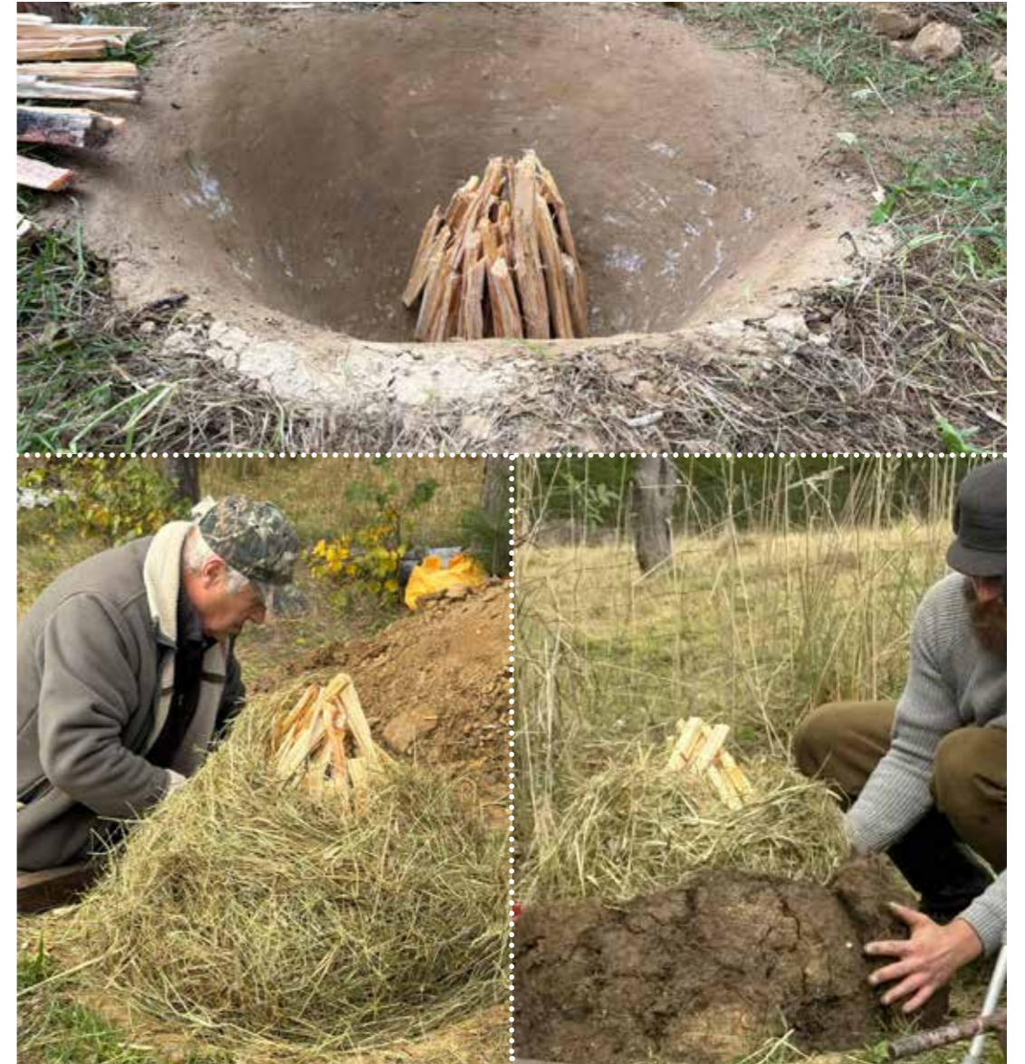
Trzon mielerza ułożony ze szczap żywicznych. Uszczelnianie mielerza warstwą zwilżonego siana. Okładanie mielerza warstwą darni w celu pełnego uszczelnienia.
